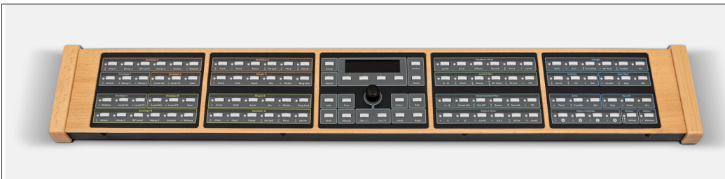
Über das große, fünfgeteilte Panel mit 96 Tastern und LEDs wird die Klangeditierung vorgenommen.
